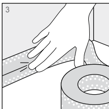
3 Luk forbindelserne til gulvet med vandtæt membranmasse og fugetape
